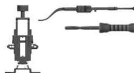
Calibrador de tamaño (E1100101), pies del calibrador (E110013X), estilete del calibrador (E1100112) y broca de 3,2 mm (E1000201).
